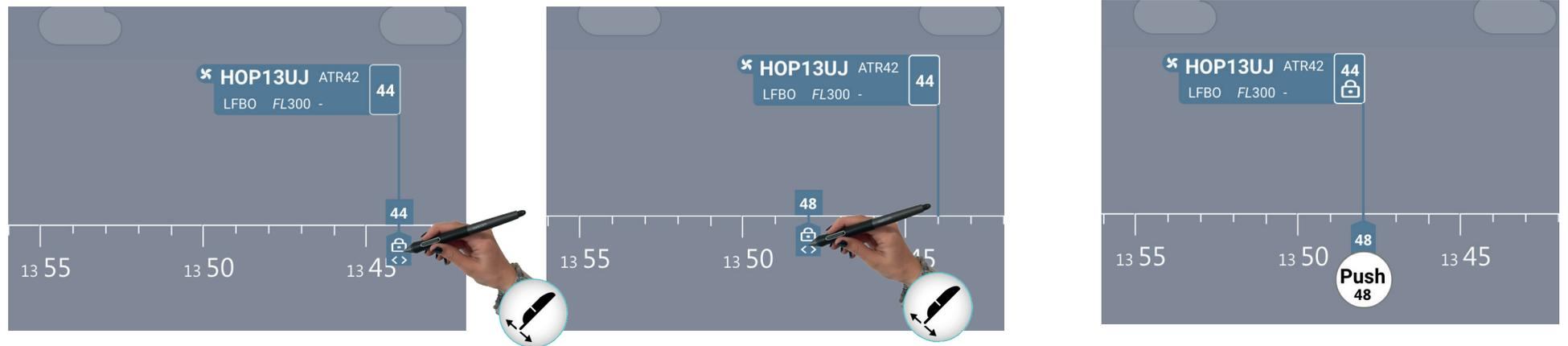
Au survol, la poignée de force change d'apparence et un mouvement de **drag** à partir de cette poignée permet de modifier la Target Time. A la fin de l'action le bouton Push apparait et permet de réaliser l'action de Push de la Target Time. La conséquence du Force sur le vol est répercutée sur sa représentation sur la timeline piste.
