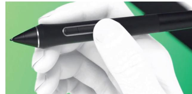
Non seulement la technologie offerte permet un suivi du stylet sur la Wacom®, mais également une prise en compte de la pression exercée ainsi que de l'inclinaison du stylet.
